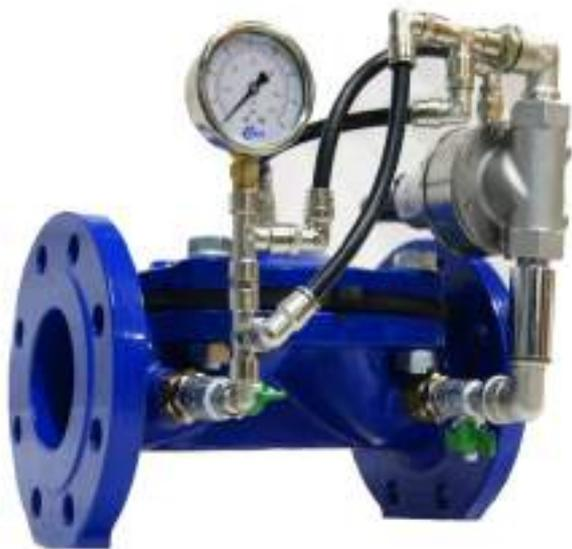
Клапан регулирует давление воды «до себя», то есть клапан ограничивает максимальное давление воды во входном трубопроводе, на отвод от которого он установлен, путем сброса излишка воды.
